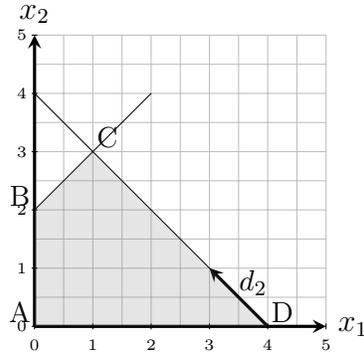
FIGURE 5 – Direction de base admissible correspondant à  $x_2$
